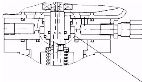
Вариант рабочего регулятора в применении с монитором
