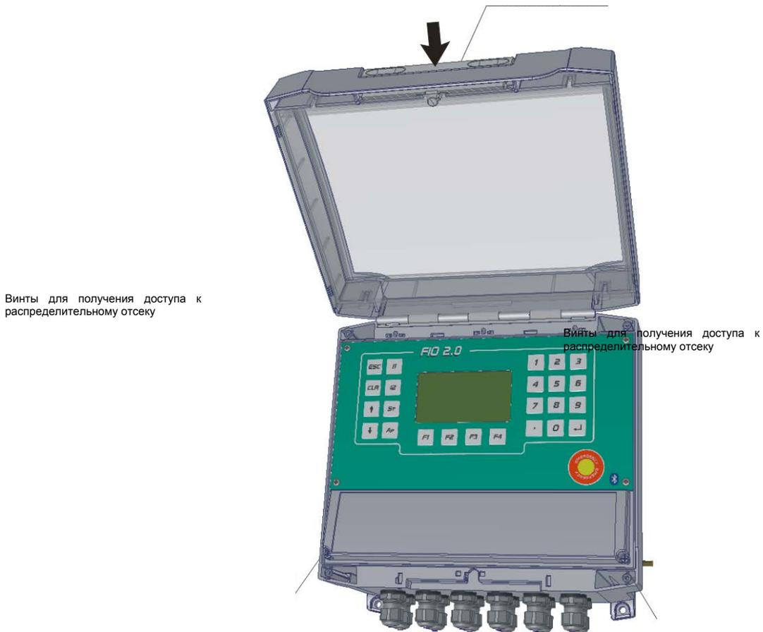
Рисунок 21 Доступ к распределительному отсеку
