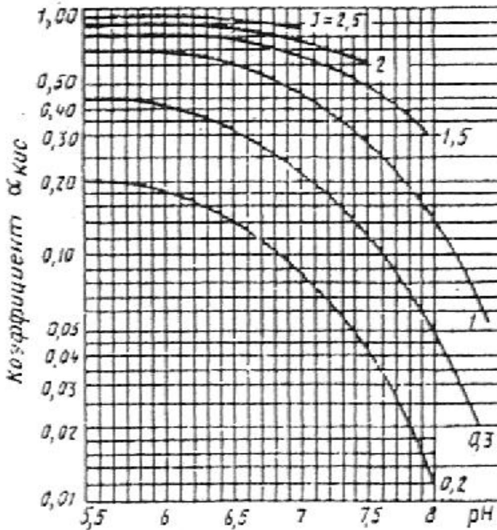
Рис. 3. Номограмма для определения коэффициента  $\alpha_{KHCO_3}$  при расчете дозы кислоты
